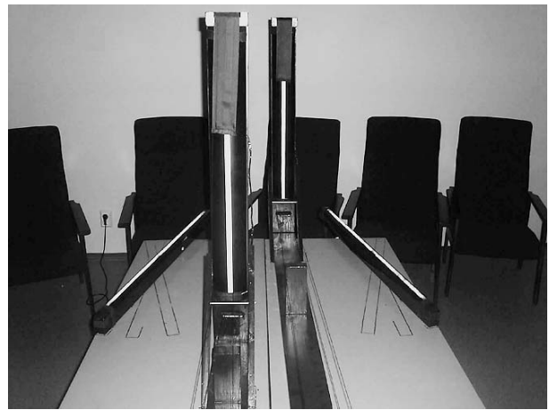
Рис. 1. Общий вид экспериментальной установки с позиции испытуемого (при фотовспышке). Фоновые лампы в данном случае создают фон в линейной перспективе, линии на столе обозначают положение ламп в параллельном и обратном фоне.
