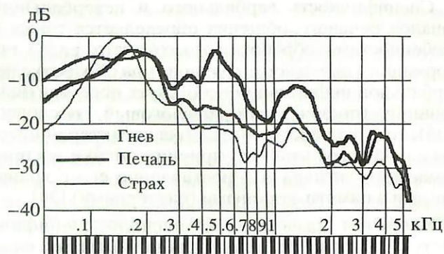
Рис. 3. Интегральные спектры голоса актера О. Басилашвили (из теста В.П. Морозова на эмоциональный слух) при произнесении фразы “Прости, я сам все расскажу” с разными эмоциональными оттенками показывают, что при выражении гнева значительно повышается уровень высокочастотных обертонов, что приводит к увеличению резкости, “металличности” голоса, а при выражении печали и особенно страха уровень высоких обертонов снижается, голос становится “тусклым” и “глухим”. По вертикали — относительный уровень спектральных составляющих (дБ), по горизонтали — их частота (кГц).
