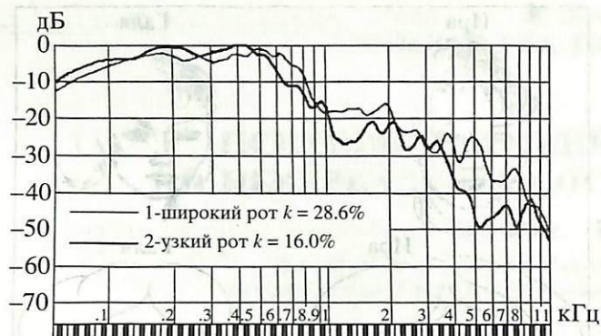
Рис. 2. Сравнительные интегральные спектры речи при разной ширине рта. Широкий рот: k = (\Sigma \Delta F / \Sigma F) \times 100\% = 28.6\% . Узкий рот: k = (\Sigma \Delta F / \Sigma F) \times 100\% = 16.0\% , где k – коэффициент, характеризующий процентное отношение акустической энергии высокочастотной части спектра звука в полосе \Sigma \Delta F (1 кГц–11 кГц) к энергии всего звука в целом \Sigma F (0.1 кГц–11 кГц). Информативными признаками распознавания аудиторами ширины рта говорящего и других его особенностей являются не только значения k , но и расположение формантных максимумов в спектрах распознаваемых звуков. По горизонтали – частота спектральных составляющих (кГц); внизу – условное изображение клавиатуры рояля, соответствующей по звуковысотным отношениям логарифмической шкале (кГц). По вертикали – относительный уровень интенсивности (дБ).
